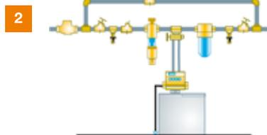
1 - Esquema de instalación filtro de seguridad con dosificador Cillit Immuno
