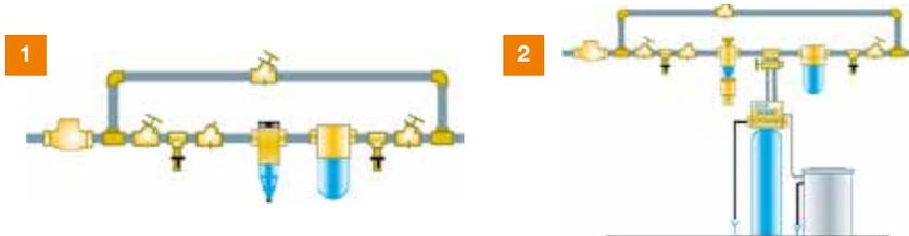
1 - Esquema de instalación filtro de seguridad con dosificador Cillit Immuno
