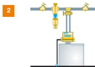
1 - Esquema de instalación descalcificador para agua potable con filtro y dosificador.
