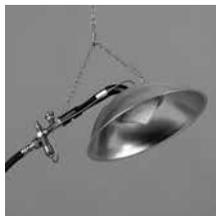
Radiador de infrarrojos de placa metálica de acero inoxidable con doble superficie radiante, para pequeñas aplicaciones avícolas y porcinas de maternidad o destete. Potencias de 1 y 1,5 kW, modulantes desde el 10-20% al 100% de la potencia nominal.
