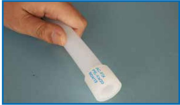
2. Montar el anillo de plástico en la tubería de forma que sobresalga un poco (máx. 1mm) del extremo de la tubería. El anillo de plástico ha de estar bien ajustado a la tubería. Si queda suelto, meterlo unos centímetros en la tubería y expandir un poco el extremo de ésta sin el anillo de plástico. Después, volver a poner el anillo de plástico en la posición correcta en el extremo de la tubería.
