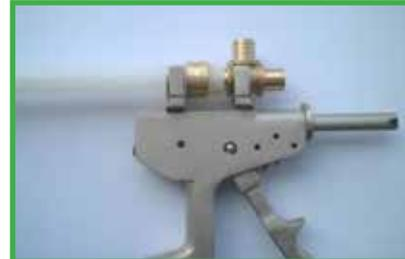
**6.** Colocar el tubo y el accesorio en la prensa.
