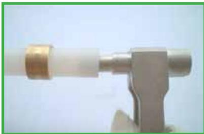
**3.** Abocardar ejerciendo una presión progresiva sobre la empuñadura y efectuando a la vez un movimiento rotatorio dentro del tubo.
