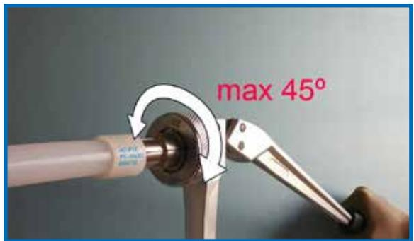
4. Presionar lentamente las palancas hasta juntarlas por completo. En los casos de las dimensiones de tubos de 20 y superiores, mantener juntas las palancas durante unos 3 segundos.
