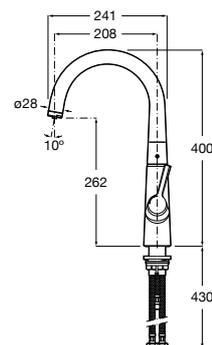
Mezclador monomando para cocina con caño curvo giratorio y función filtro de agua. Incluye enlaces de alimentación flexibles. Cromado. Apertura en agua fría.
