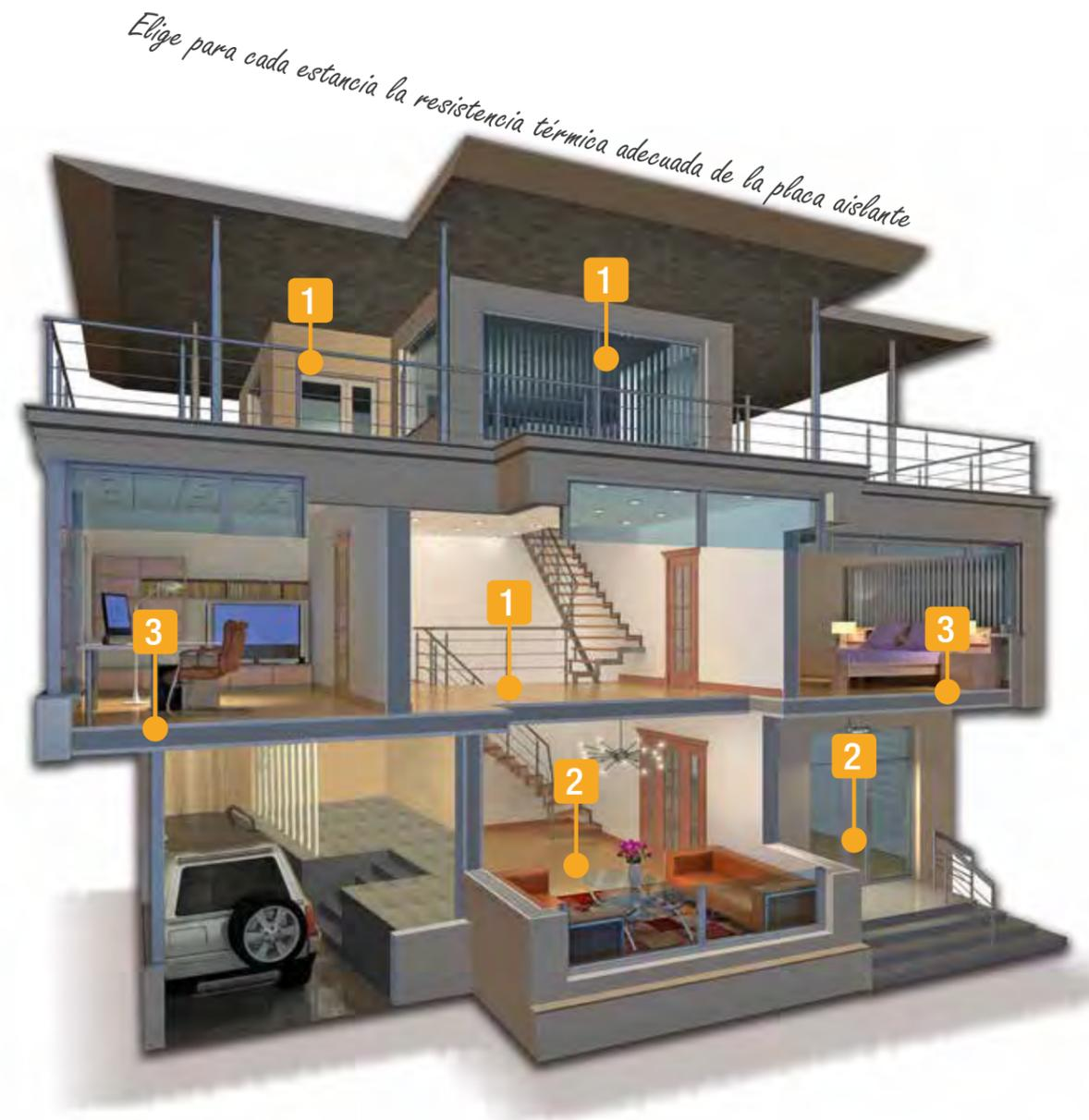
Resistencia térmica mínima de las capas de aislamiento debajo del sistema de calefacción por suelo radiante según la norma UNE-EN 1264 en función del local:
