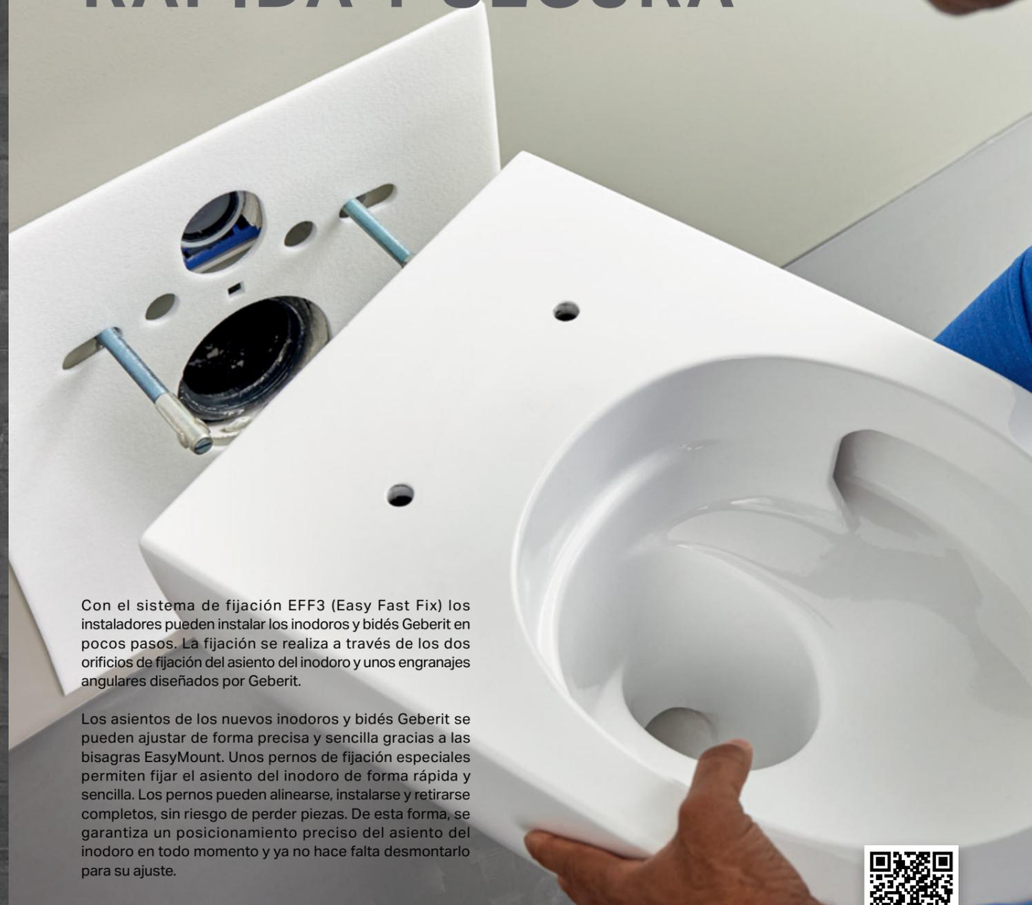
Con el sistema de fijación EFF3 (Easy Fast Fix) los instaladores pueden instalar los inodoros y bidés Geberit en pocos pasos. La fijación se realiza a través de los dos orificios de fijación del asiento del inodoro y unos engranajes angulares diseñados por Geberit.
