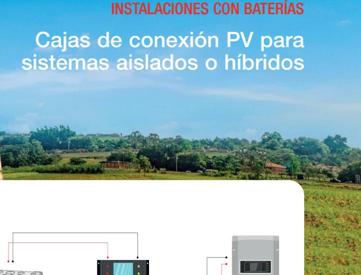
Los sistemas de generación fotovoltaica aislados o híbridos se basan en el uso de **baterías** para la acumulación de energía. Estos sistemas se caracterizan por trabajar en tensiones muy bajas compatibles con los diferentes tipos de baterías (12/24/48V). Consecuentemente para conseguir potencias elevadas deberemos buscar equipos con corrientes nominales de carga elevadas instalando múltiples cadenas en paralelo.
