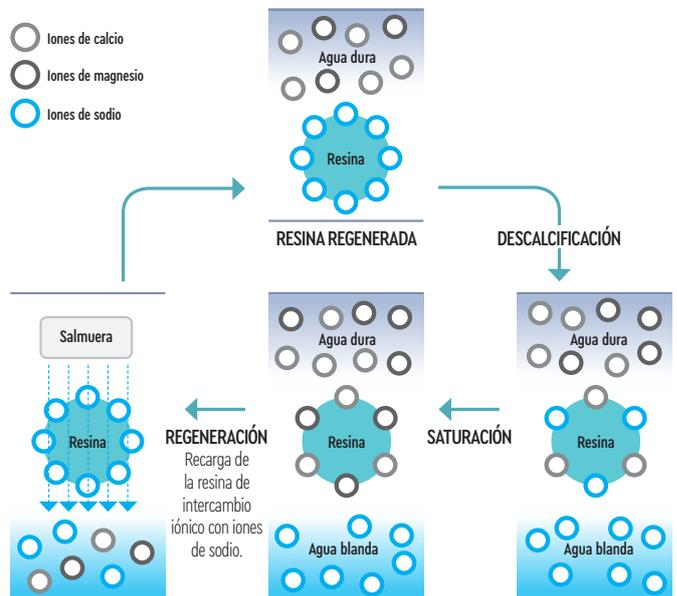
Tras el lavado de la resina de intercambio iónico con la salmuera regeneradora, los iones cálcicos y otras impurezas se eliminan junto con el agua salina a través del desagüe.
