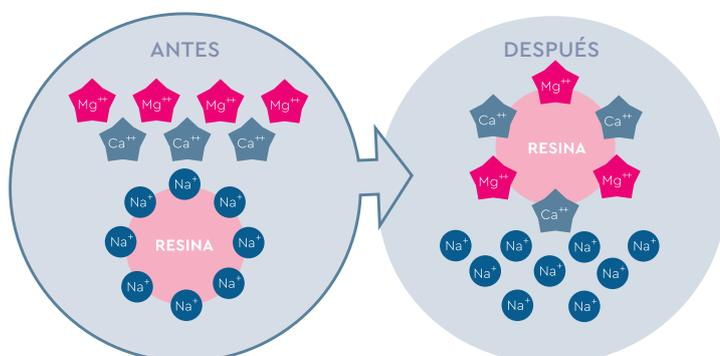
En la resina se produce el intercambio entre el sodio y los iones que provocan la dureza, que quedan retenidos. Una vez agotada la resina, el proceso se invierte, regenerándose con una solución saturada de NaCl.
