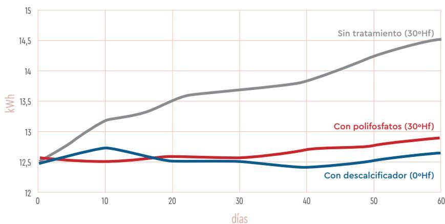
Condiciones test: caldera condensación, funcionamiento 3h/día durante 60 días, T: 30°C, caudal 6 l/min
